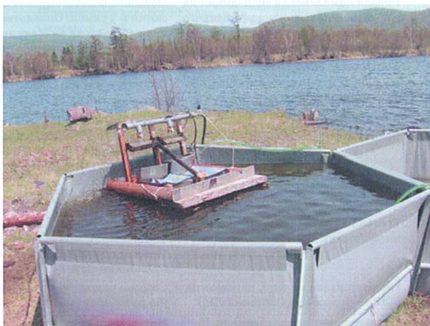
Рис. 3. Модульная установка для инкубации икры сахалинского осетра, смонтированная в береговом бассейне
